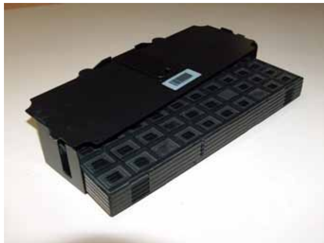
Рис. 7 Кассета для хранения матричных поддонов
