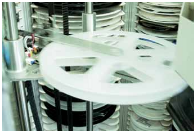
Рис. 3 Автоматический манипулятор захватывает катушку
