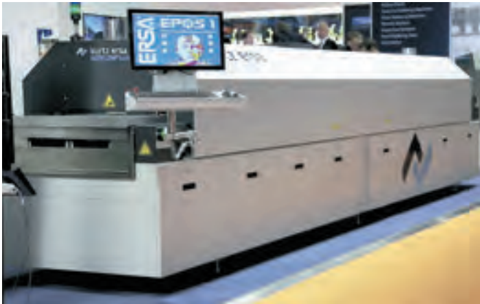
5 Конвекционная печь Hotflow 4/20 на стенде ERSA
