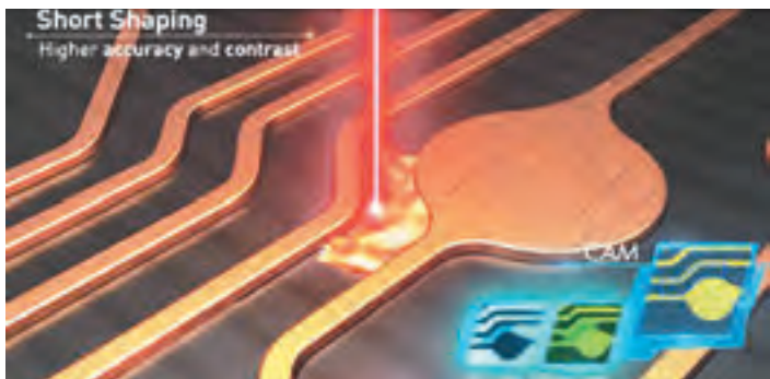
5 Процесс ремонта обрыва
