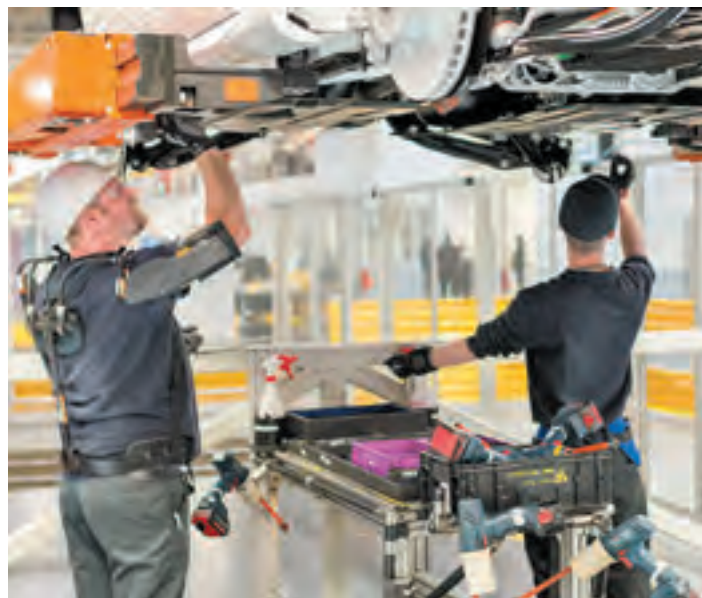
Сборочные операции на автомобильном заводе с применением экзоскелетов
