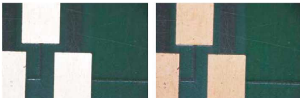
Рис. 15. Обычное изображение (слева) и изображение, полученное с применением функции Anti Halation (справа)
